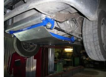
Устанавливается на поперечину DRIVE и DRIVE ПУ (полиуретановые сайлентблоки) спереди и распорку нижнюю сзади.
