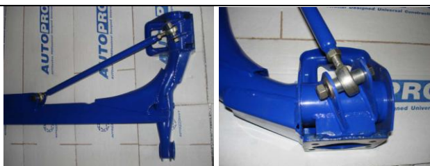
Дополнительные усилители обеспечивают продольную жесткость, растяжки с шаровыми соединениями ШС обеспечивают жесткость продольных элементов, не увеличивая расчетную поперечную жесткость, что очень важно для полузависимой подвески.
