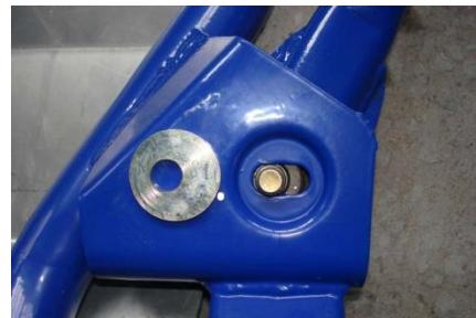
Схема регулировки развала и схождения остается серийной, схождение регулируется длиной тяг рулевого механизма, развал вращением эксцентрикового болта крепления кулака к стойке. Кастрор регулируется подбором шайб из комплекта, причем верхняя и нижняя шайбы одной стороны должны быть одинаковы.
