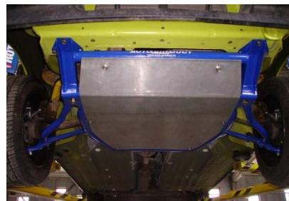
По окончании всех работ отрегулировать подвеску на стенде. **Развал передних колес выставить -30 минут**, вместо серийного значения 0. Это повысит устойчивость автомобиля. Рекомендуется устанавливать подрамник с защитой. Вы можете выбрать 4 мм. алюминиевую или 2 мм. стальную оцинкованную защиту.
