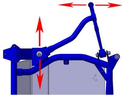
Кастор увеличен относительно серийного на 1.5 градуса. Шайбы со смещением - для выравнивания кастрора по сторонам. Подкладывая эксцентриковые шайбы, перемещаем переднюю часть рычага внутрь или наружу, при этом наружная часть рычага перемещается, соответственно вперед или назад, увеличивая или уменьшая кастрор.
