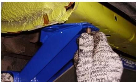
В передней части подрамник крепится на три болта с шайбами гровера с каждой стороны (взять из комплекта), протяните гайки крепления подрамника сзади.
