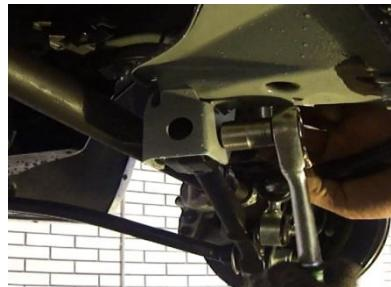
Демонтировать гайку и болт крепления рычага;
