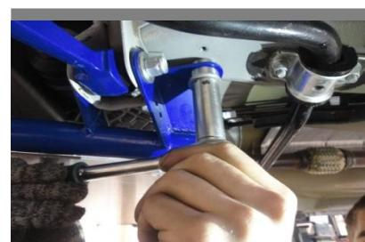
Отверстия заднего кронштейна совпадают с отверстиями кронштейна на кузове. После этого необходимо вставить рычаг в кронштейн и ввести болт сквозь кронштейн и рычаг так, чтобы шляпка болта была спереди!
