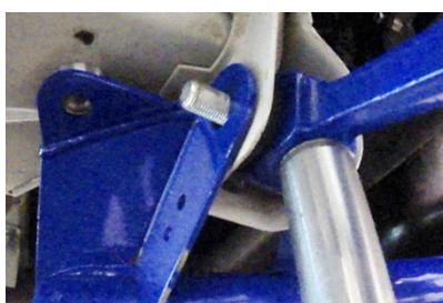
Сначала необходимо совместить отверстия задних охватывающих кронштейнов подрамника с отверстиями охватываемых кронштейнов. Штифты при этом должны войти в базовые отверстия. Для удобства можно поджать жесткий рычаг подрамника стойкой.
