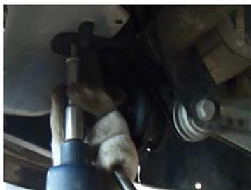
Открутить болты М12 крепления поперечины.
