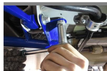
Отверстия заднего кронштейна совпадают с отверстиями кронштейна на кузове. После этого необходимо вставить рычаг в кронштейн и ввести болт сквозь кронштейн и рычаг так, чтобы шляпка болта была спереди! Наживите гайку. Справа следует аккуратно поддомкратить колесо, привод освободит доступ к кронштейну. После этого наживите и затянуть болт с шайбой (поставляется в комплекте) к штифту, установленному в базовом отверстии кузова.
