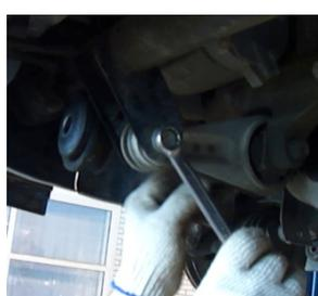
Открутить болт М 10 крепящий дополнительную опору силового агрегата к поперечине и демонтировать ее.
