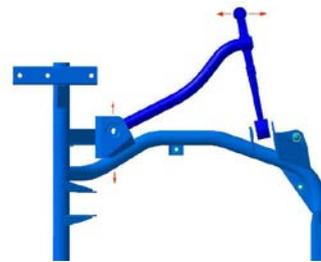
Кастор увеличен относительно серийного на 1,5 градус. Шайбы со смещением - для выравнивания кастора по сторонам. Подкладывая эксцентрик шайбы, перемещаем переднюю часть рычага внутрь или наружу, при этом наружная часть рычага перемещается, соответственно вперед или назад, увеличивая или уменьшая кастор.
