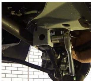
Демонтировать гайку и болт крепления рычага; открутить болт крепления стойки стабилизатора и демонтировать ее.
