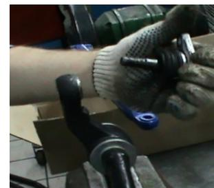
Отсоединить рычаг от шаровой опоры
