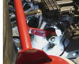
6. Затянуть гайки на растяжке СА, нижнюю ключом на 17, верхнюю – на 15.
