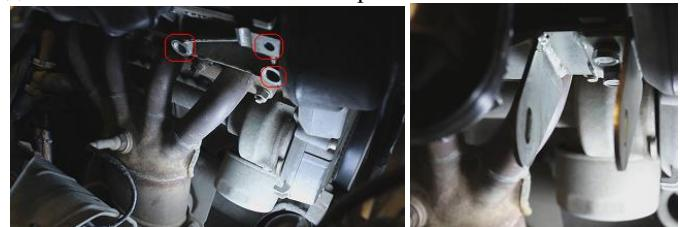
3. Открутить 6 гаек M8 крепления стоек передней подвески к кузову
