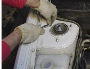
4. Установить распорку на 3 шпильки с одной стороны, сдвинуть наружу и установить на 3 шпильки вторую сторону и затянуть гайки M8 с моментом затяжки 19,6 - 24,2 Н\*м
