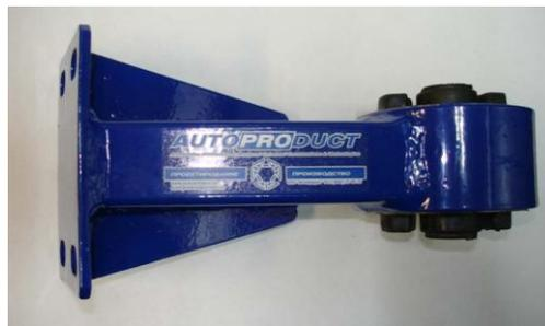
Дополнительную жесткость кронштейна обеспечивает конструкция коробчатого сечения. Опора ориентирована таким образом, чтобы обеспечить прогрессивный прирост жесткости при колебаниях.
