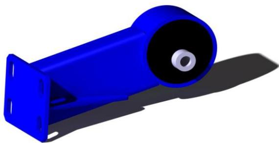
Устанавливается на серийные точки крепления – 4 болта к блоку силового агрегата, сайлентблок – к кронштейну кузова. При установке рекомендуется ослабить крепление остальных опор, покачать силовой агрегат в произвольных направлениях руками, затем затянуть все точки крепления.
