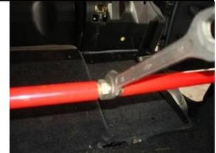
4. Открутите и снимите кронштейны крепления сидения и ремни безопасности задние. Установите трубу нижнюю. Снова установите сидение и ремни безопасности, прижав при этом трубу нижнюю.
