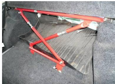
1. Освободите доступ к верхней опоре стоек задней подвески, снимите кронштейн крепления спинки задних сидений.
