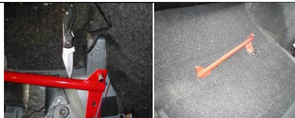
5. Установите диагональные трубы на шпильки конусные верхней и нижней трубы, если необходимо отрегулируйте длину. Затяните гайки M12 крепления диагональных труб.
