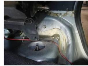
2. Опустите диск в углубление опоры с наживленными болтами М6. Для равномерной посадки подстучите рукояткой молотка, полукруглые шляпки болтов должны зацепиться за отбортовку на диске. Оденьте трубу (не прикручивая) на шпильки М12, подтяните гайки М6, закрутите полностью. Верните кронштейн крепления спинки задних сидений на место. Снимите трубу. Прорежьте коврик, наденьте коврик, так, чтобы шпилька М12 и конус под ней были полностью открыты. Закрепите боковую пластмассовую накладку и коврик.
