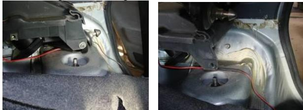
2. Опустите диск в углубление опоры с наживленными болтами M6. Для равномерной посадки подстучите рукояткой молотка, полукруглые шляпки болтов должны зацепиться за отбортовку на диске. Оденьте трубу (не прикручивая) на шпильки M12, подтяните гайки M6, закрутите полностью. Верните кронштейн крепления спинки задних сидений на место. Снимите трубу. Прорежьте коврик, наденьте коврик, так, чтобы шпилька M12 и конус под ней были полностью открыты. Закрепите боковую пластмассовую накладку и коврик.
