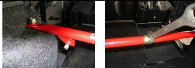
4. Открутите и снимите кронштейны крепления сидения и ремни безопасности задние. Установите трубу нижнюю. Снова установите сидение и ремни безопасности, прижав при этом трубу нижнюю.
