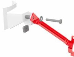
Завести закладную шайбу в кронштейн кузова, между ушами кронштейна установить распорную втулку, далее совместить отверстия втулки и усилителя, и вкрутить болт М10 с шайбой.
