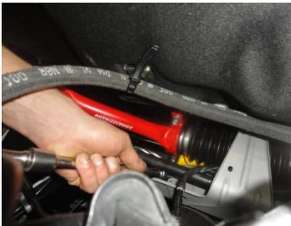
Установить усилитель щитка передка, затем прикрутить 2 гайки М8.
