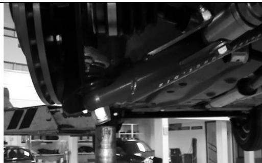
Окончательную затяжку гаек - M 24 с моментом 18кг\м, M30 с моментом 20кгс\м, M16 на растяжке 16,0-18,0 кгс\м производить при поджатом рычаге, например гидравлической стойкой, как показано на рисунке. После затяжки необходимо застопорить гайки с помощью шайб, входящих в комплект.
