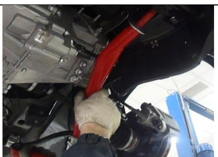
Ставим рычаги от Автопродукт на место штатных и вкручиваем болты (в комплекте), но не затягиваем.
