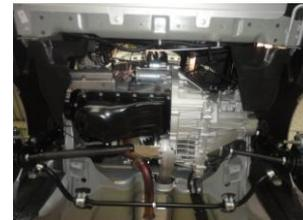
Открутить переднюю гайку растяжки болты крепления кронштейна демонтировать кронштейн. Открутить болты шаровой и стойки стабилизатора. Открутите гайку крепления рычага к кузову и выньте болт. Справа, для доступа к болту аккуратно приподнимите гидравлической стойкой колесо, привод освободит доступ к кронштейну.
