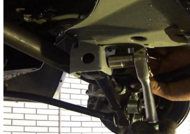
Демонтировать гайку и болт крепления рычага; демонтировать серийный рычаг.
