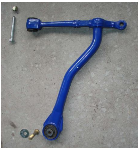
Завести переднюю часть рычага между горизонтальными полками кронштейна переднего, вставить болт вертикально. Задняя часть рычага устанавливается подобно серийному.
