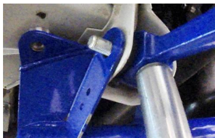
Сначала необходимо совместить отверстия задних охватывающих кронштейнов подрамника с отверстиями охватываемых кронштейнов. Штифты при этом должны войти в базовые отверстия. Для удобства можно поджать жесткий рычаг подрамника стойкой.
