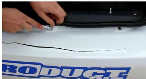
3. Перед установкой наклейки необходимо обезжирить поверхность бампера автомобиля в местах контакта со скотчем. Обработать место установки праймером 3м
