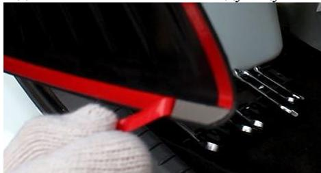
5. Приложить накладку к бамперу, наживить болты, отрегулировать зазоры, затянуть болты.
