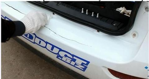
4. Перед установкой наклейки, отогните часть защитной пленки на 20-30 мм, так, чтобы она выступала за контур изделия. Это облегчит последующую наклейку.
