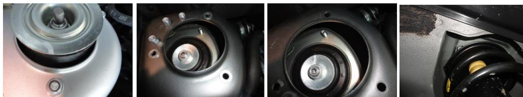
Открути гайки убери шайбы отените амортизатор подставьте усилитель закрутите болты
