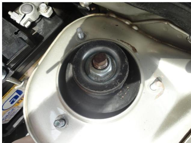
на чашке есть выпуклости от амортизатора и со временем появляются трещины
