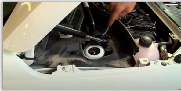
6. – Доработать пыльник, установленный на раме ветрового окна по месту.
