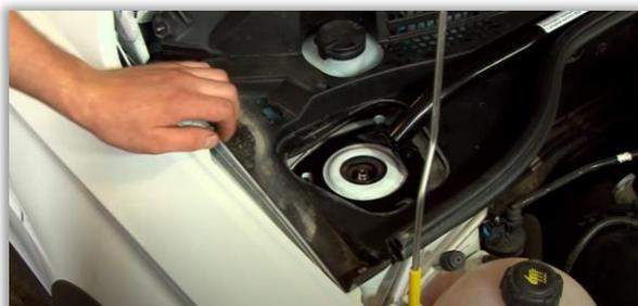
5. - Открутить нижние гайки крепления капота
