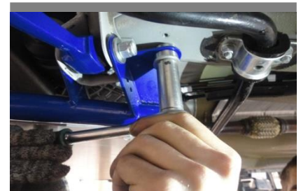
Отверстия заднего кронштейна совпадают с отверстиями кронштейна на кузове. После этого необходимо вставить рычаг в кронштейн и ввести болт сквозь кронштейн и рычаг так, чтобы шляпка болта была спереди! Наживите гайку. Справа следует аккуратно поддомкратить колесо, привод освободит доступ к кронштейну. После этого наживить и затянуть болт с шайбой (поставляется в комплекте) к штифту, установленному в базовом отверстии кузова.
