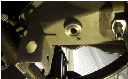
В базовое отверстие необходимо установить штифт.
