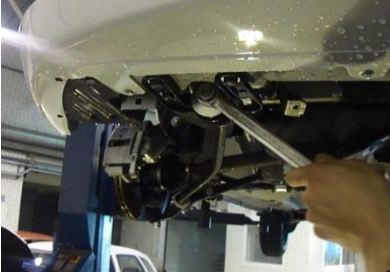
Открутить болты крепления передних кронштейнов
