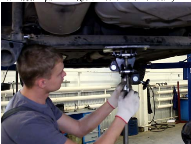
12. Открутить хомут и снять глушитель
