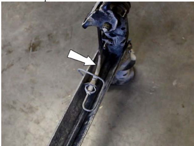
14. Снять тормозные шланги
