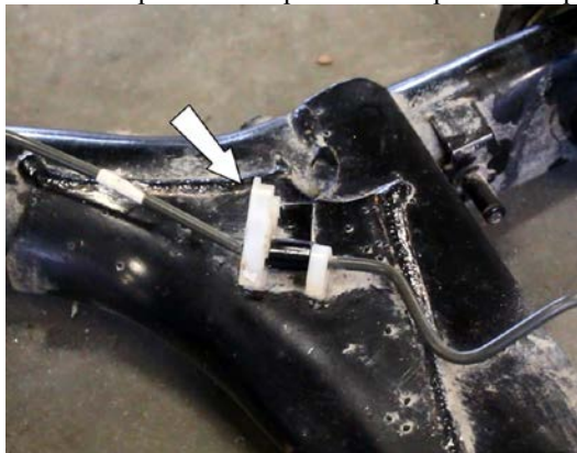
15. Снять кронштейн крепления тормозных трубок
