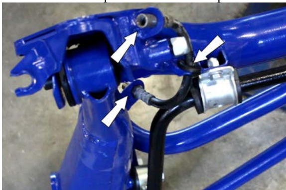
16. Установить тормозные шланги в кронштейны ЗНП
