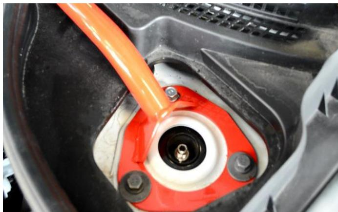
6. Установить кронштейн пневмогидроцилиндра к упорам капота
