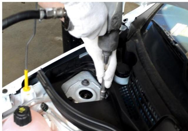
3. Открутить нижние гайки крепления упора капота гайки
