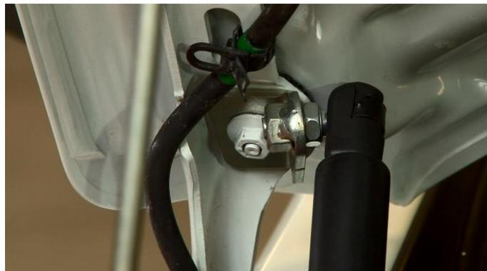
7. Равномерно затянуть гайки крепления пневмоцилиндров к кронштейнам
