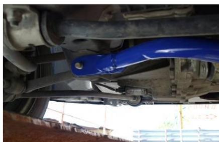
Наденьте проушину распорки на выступающую резьбовую часть болта.
