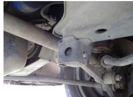
Удерживая накидным ключом 19 головку болта рычага, открутите накидным ключом 19 гайку и замените болт на более длинный из комплекта «АУТОПРОДУКТ». Аналогично замените болт с другой стороны, не выводя резьбовую часть за плоскость кронштейна рычага (см. рисунок).
