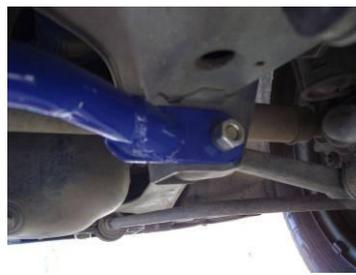
Накиньте гроверы и гайки на болты и произведите затяжку.
