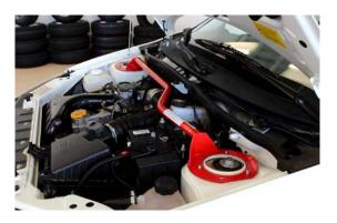
3. Установите 6 шайб, сверху распорки и закрутите 6 гаек крепления опор
