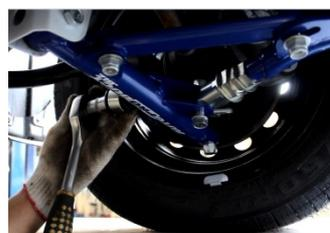
Устанавливаем рычаги от Автопродукт на место штатных в обратном порядке и наживляем все болты и гайки.
