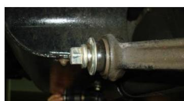
Удерживая накидным ключом 19 головку болта нижнего рычага, открутите накидным ключом 24 гайку, до образования зазора между шайбой и гайкой 7мм.
