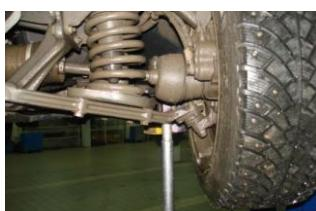
Окончательную затяжку гаек производить при поджатом рычаге, например гидравлической стойкой, как показано на рисунке слева.
