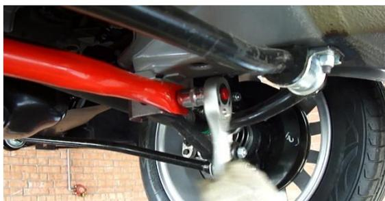
Наденьте распорку на выступающую резьбовую часть болта.
