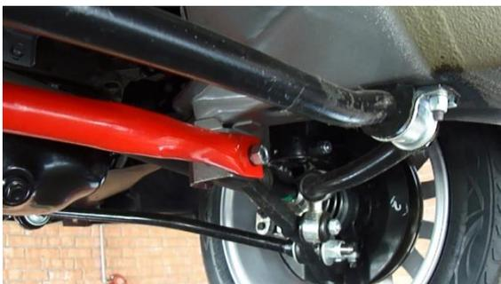
Надеть гроверные шайбы и гайки на болты и произвести затяжку.
