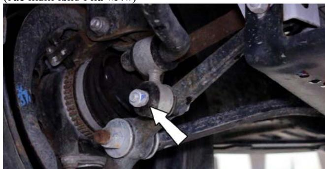
4. Открутить и снять по две крепежные гайки кронштейнов стабилизатора с обеих сторон автомобиля (гаечный ключ на «13»)
