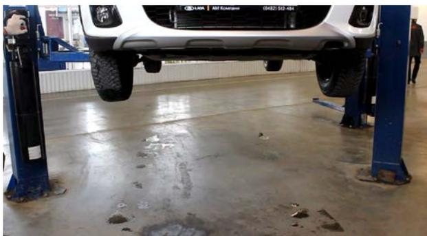
2. Открутить и снять по одной крепежной гайке стоек стабилизатора с обеих сторон автомобиля (гаечный ключ на «17»)
