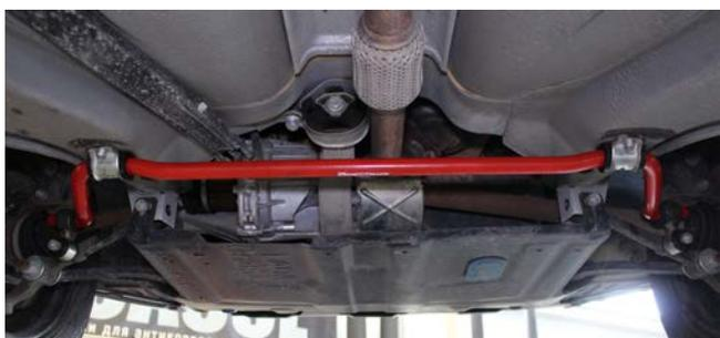
6. Установите автомобиль на землю на все колеса, после чего затяните все крепежные гайки деталей стабилизатора поперечной устойчивости при нагруженной подвеске
