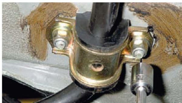
4. Демонтировать стабилизатор в сборе с кронштейнами и стойками
