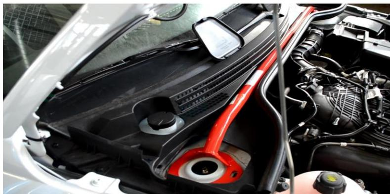
4. Закрутить 6 болтов\* крепления распорки
