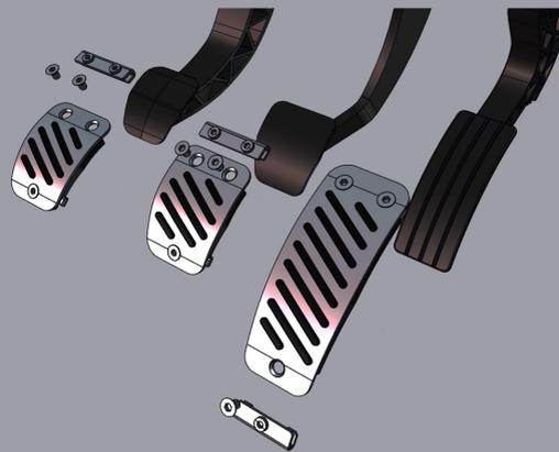
2. Открутить винты (инструмент - шестигранный ключ 3) накладок как изображено на рисунке (по 2 винта сверху на накладках педалей сцепления и тормоза, и один винт снизу накладки педали газа).
