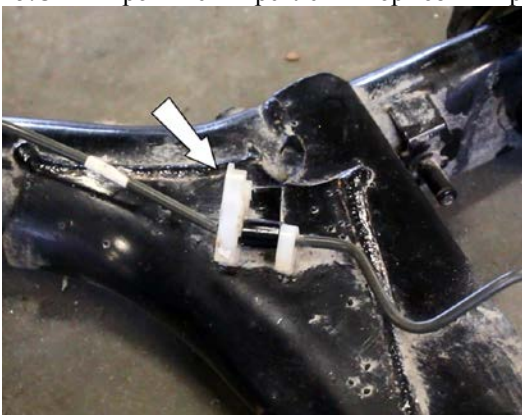
15. Снять кронштейн крепления тормозных трубок
