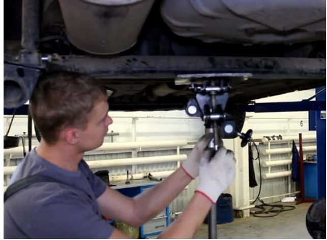
12. Открутить хомут и снять глушитель
